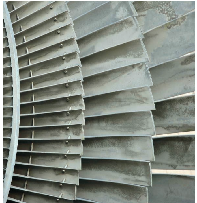
El depósito de sílice en los álabes de las turbinas es un problema grave.
