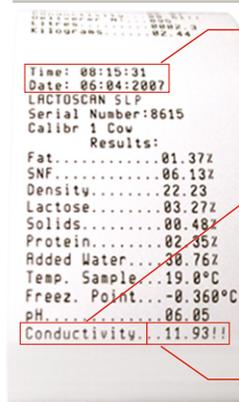
Conductividad el sensor integrado de conductividad analiza el rendimiento alto del punto de congelación
